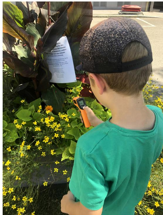
Abbildung 32: Hier wurde während der Schnitzeljagd die Oberflächentemperatur von begrünten Flächen mit einem Infrarot-Thermometer gemessen.
