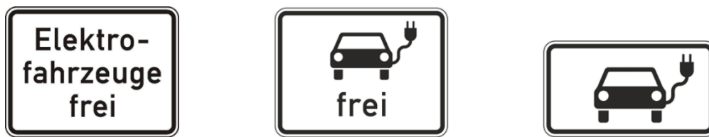
Abbildung 19: Zusatzzeichen 1026-61 „Elektrofahrzeuge frei“ (links), 1024-20 „Elektrisch betriebene Fahrzeuge frei“ (Mitte) und 1010-66 „Elektrisch betriebene Fahrzeuge“ (rechts) [eigene Darstellung]
